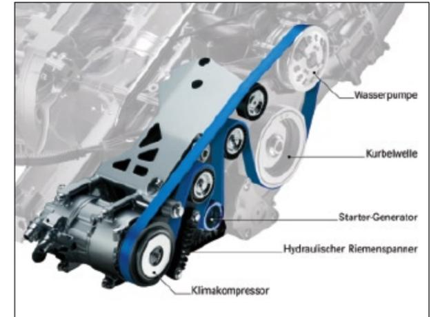
Für die ECO Start-Stopp-Funktion verwendet Mercedes-Benz einen Riemen-Starter-Generator, der auch als Lichtmaschine dient.
