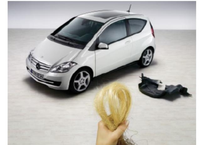
Für die Herstellung der Abdeckung der Ersatzradmulde verwendet Mercedes-Benz die zugfestesten Fasern der Abaca-Banane.
