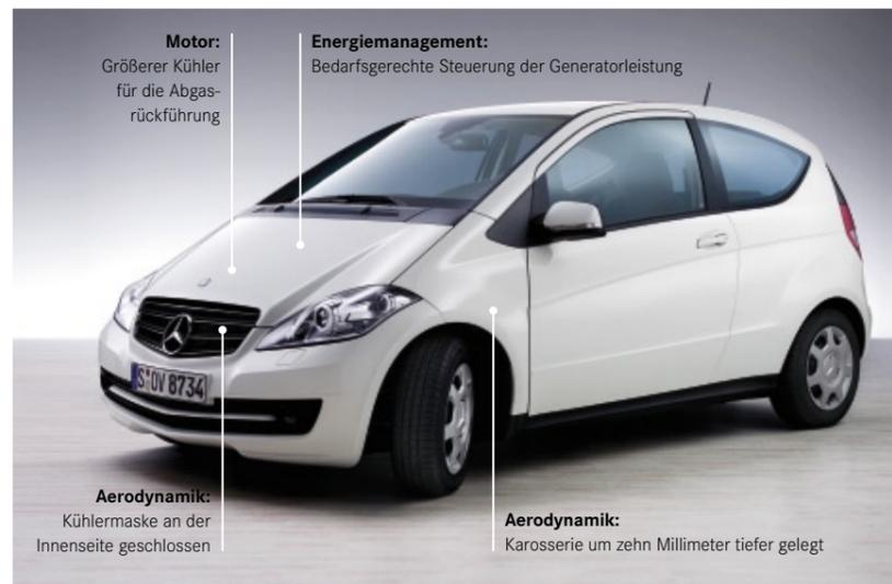
Das BlueEFFICIENCY-Paket beinhaltet unter anderem eine aerodynamisch optimierte Kühlermaske. Sie ist an ihrer Innenseite geschlossen und vermindert so das in den Motor strömende Luftvolumen; die Kühlung des CDI-Triebwerks bleibt trotzdem jederzeit gewährleistet. Außerdem ist die Karosserie um zehn Millimeter tiefer gelegt, um den Luftwiderstand weiter zu verringern.
