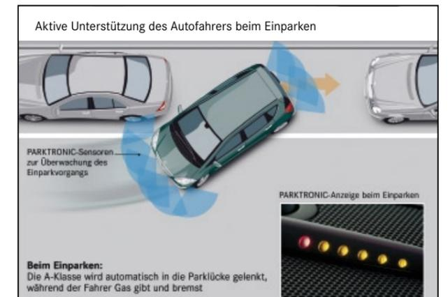
elektromechanische Servolenkung der A-Klasse versorgt, deren Elektromotor selbsttätig die notwendigen Lenkbewegungen vornimmt. Für den automatischen Einparkvorgang muss die Parklücke nur 1,30 Meter länger sein als die A-Klasse – ein Indiz für die hohe Genauigkeit der Technik. Dank der sehr kompakten Abmessungen der A-Klasse reicht für das Einparken also eine Parklücke von nur rund 5,19 Meter Länge aus.
