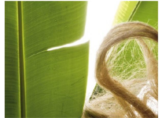
Aus dem Blatt der Abaca-Banane lässt Mercedes-Benz zugefestigte Fasern herstellen. Sie dienen als Werkstoff für einen Teil der Unterbodenverkleidung der B-Klasse.
