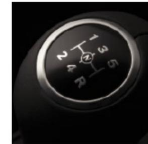
Bei den Modellen mit ECO Start-Stopp-Funktion ist die Leerlaufstellung des Getriebes am Schalthebel besonders gekennzeichnet (links). Die Erdgastanks des B 170 NGT befinden sich im Heck und unter dem Fußraum des Beifahrers (unten).
