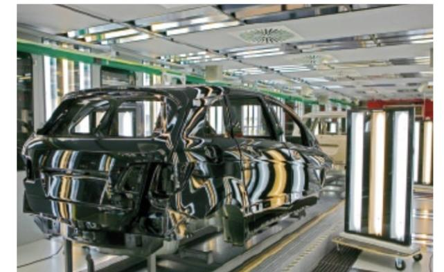
In der Lackiererei des Mercedes-Werks Rastatt werden lösemittelarme Basislacke und ein lösemittelfreier Pulverklarlack verarbeitet.
