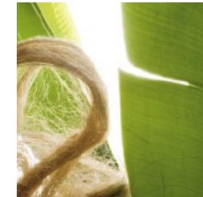
Die Fasern der Abaca-Banane gelten als besonders zugfest und sind deshalb für die Herstellung von Automobilteilen sehr gut geeignet.
