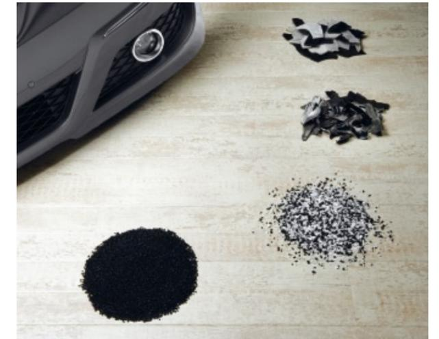
Für das Recycling werden Kunststoffe aus Altteilen in verschiedenen Arbeitsprozessen zu Granulat verarbeitet. Es dient als Werkstoff für die Herstellung neuer Automobilteile.
