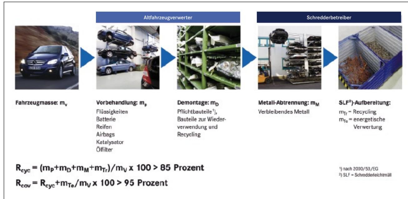
Abbildung 2-8: Stoffströme im Recyclingkonzept der B-Klasse
