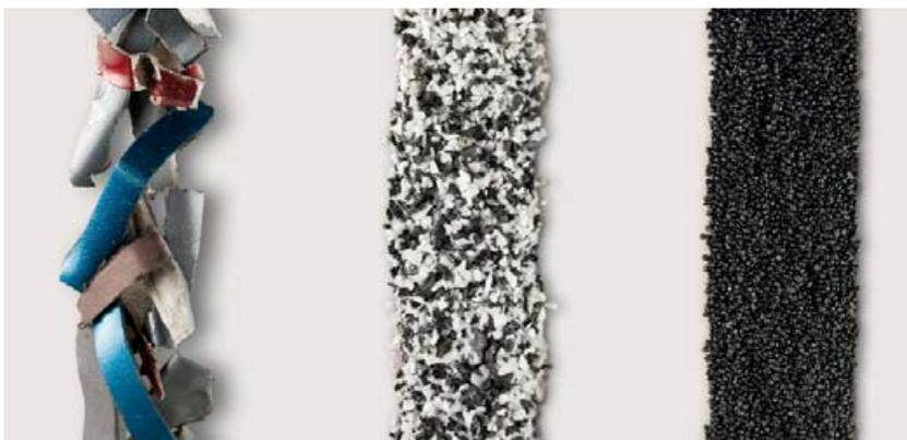
**Ausrangierte Automobil-Kunststoffe werden zu hochwertigem Granulat verarbeitet, das wiederum zur Herstellung von Rezyklat-Bauteilen dient.**
