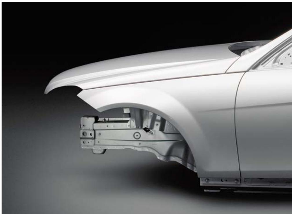
*Die Kotflügel des neuen T-Modells der C-Klasse bestehen aus Aluminium.
