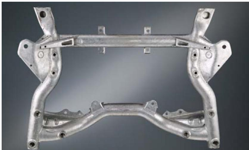
*Am Integralträger werden Motor, Vorderachse und Lenkung befestigt. Er besteht aus hochfestem Stahl.
