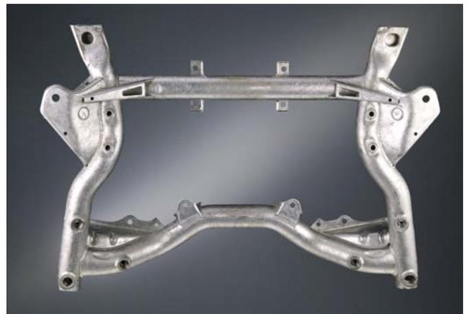
Am Integralträger werden Motor, Vorderachse und Lenkung befestigt. Er besteht aus hochfestem Stahl.
