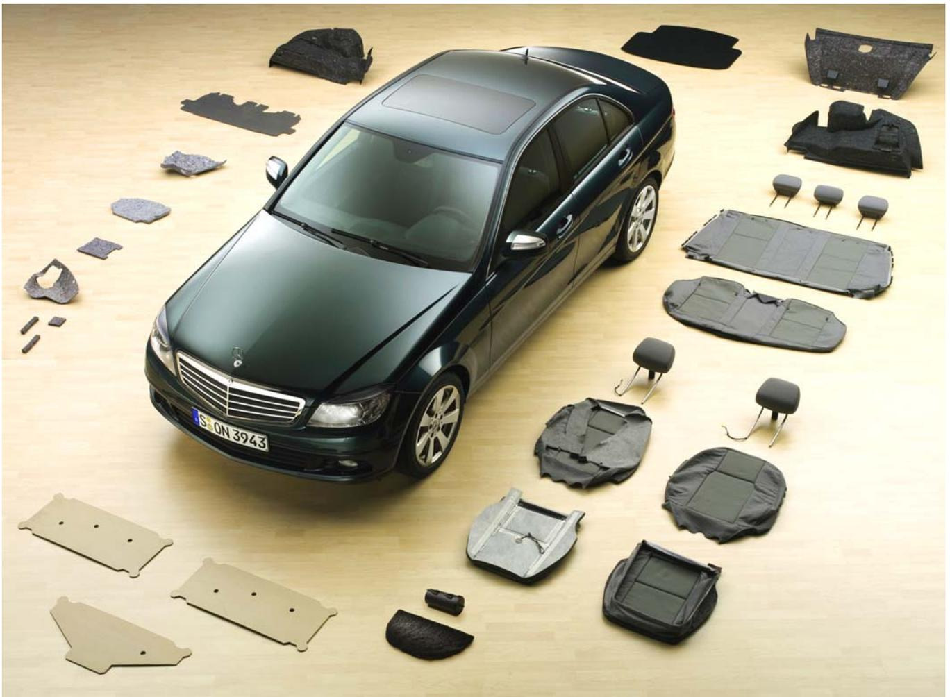
Kunststoffbauteile zurückzuführen. Abbildung 4-15 zeigt die Bauteile aus nachwachsenden Rohstoffen in der neuen C-Klasse.
