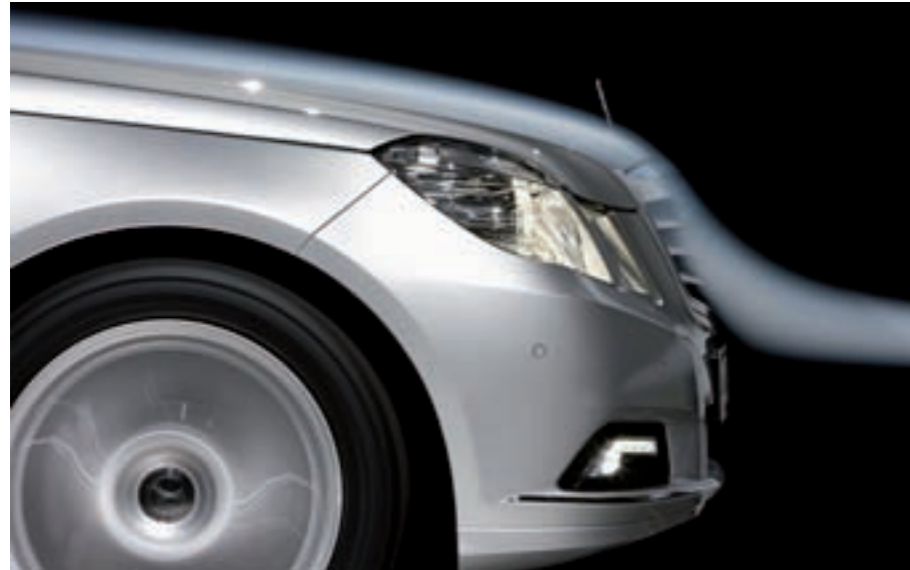
Aerodynamische Maßnahmen wie die aktive Kühlerjalousie reduzieren den Luftwiderstand und tragen zur Verbrauchsreduzierung bei.
