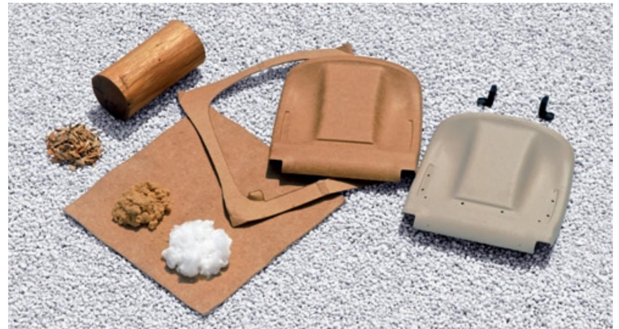
Abbildung 2-14: Verkleidung Sitzlehne aus nachwachsenden Rohstoffen
