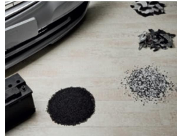
Abbildung 2-13: Rezyklat-Einsatz am Beispiel Radlaufverkleidung
