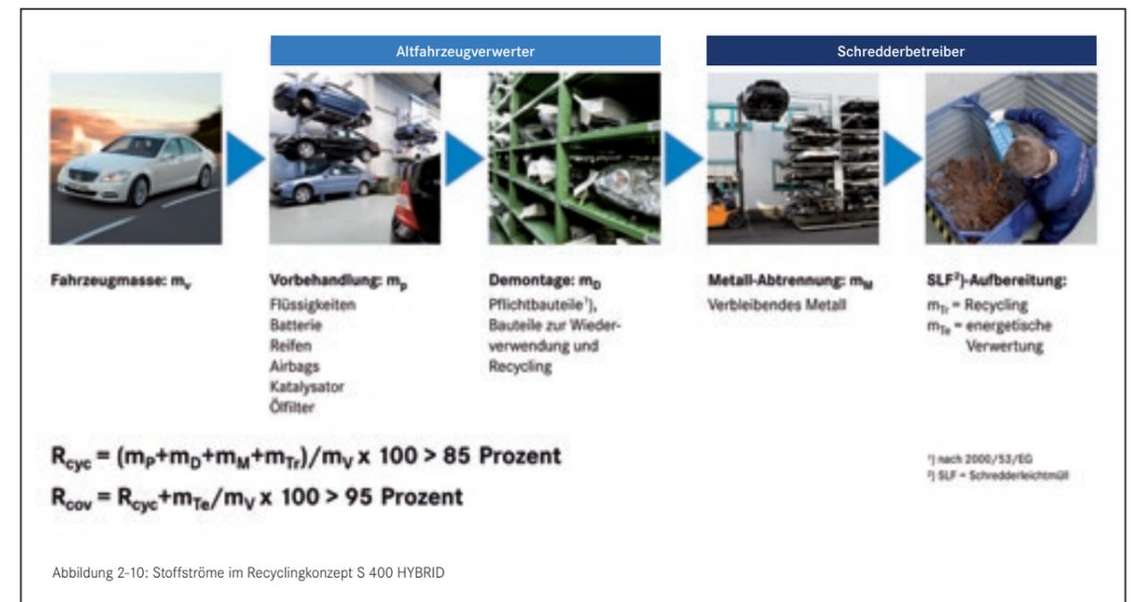
Abbildung 2-10: Stoffströme im Recyclingkonzept S 400 HYBRID
