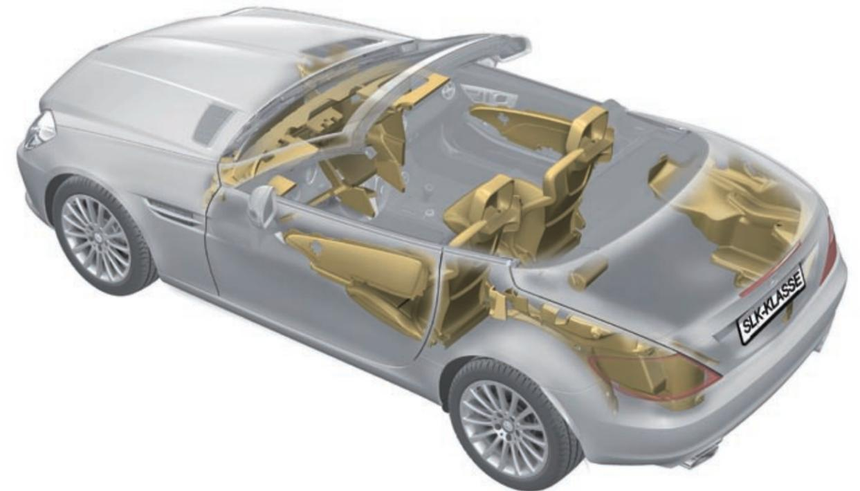
Abbildung 2-15: Bauteile aus nachwachsenden Rohstoffen in der neuen SLK-Klasse
