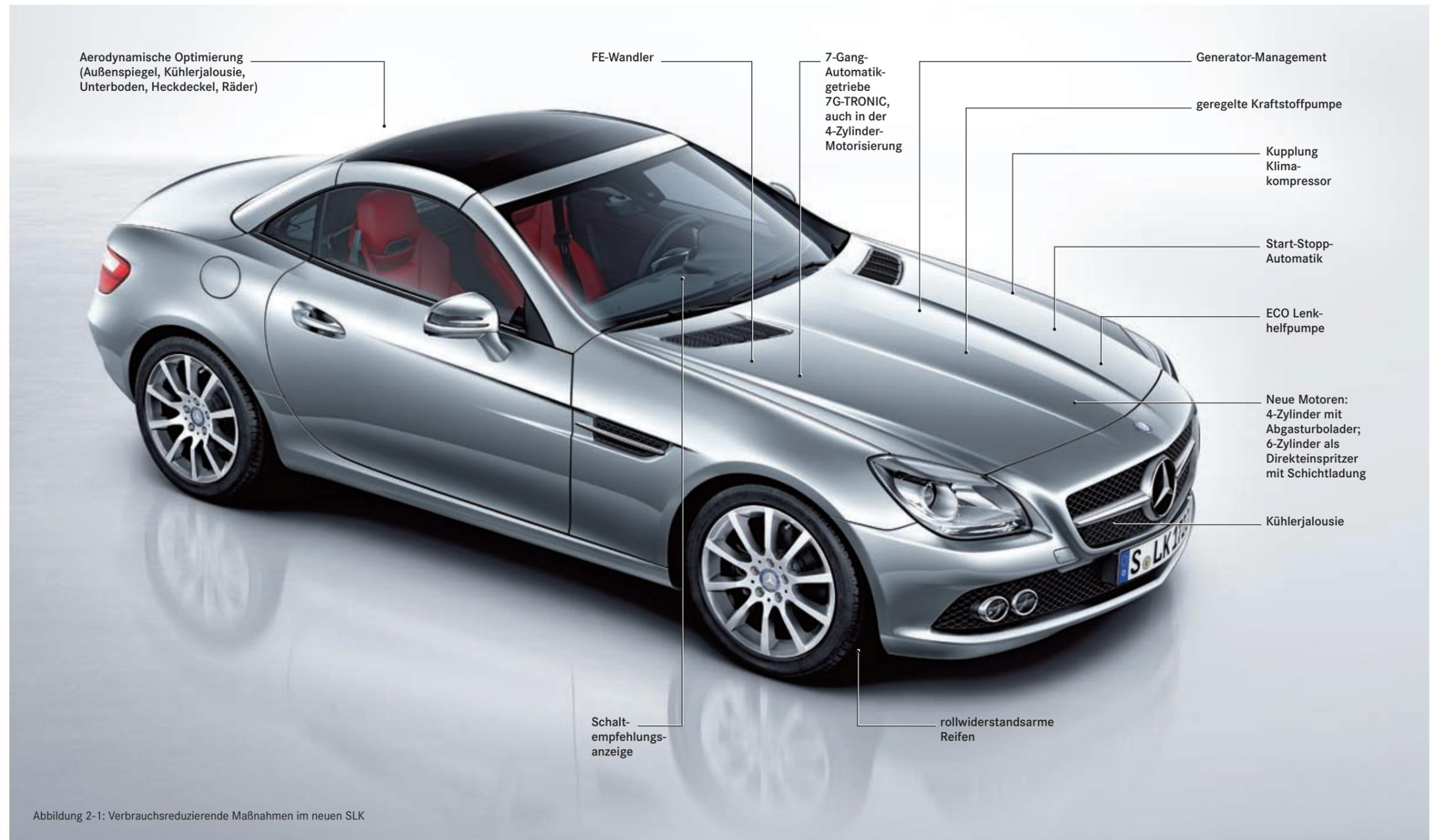
Abbildung 2-1: Verbrauchsreduzierende Maßnahmen im neuen SLK
