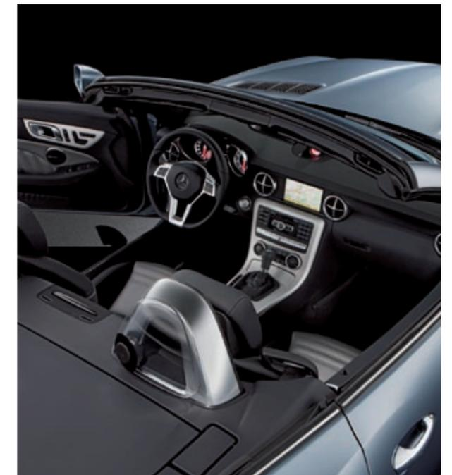
Für Materialien, die für Bauteile im Fahrgast- und Kofferraum verwendet werden, gelten zusätzlich Emissionsgrenzwerte, die ebenfalls in der DBL 8585 wie auch in bauteilspezifischen Liefervorschriften festgelegt sind. Die kontinuierliche Reduktion der Innenraumemissionen ist dabei ein wesentlicher Aspekt der Bauteil- und Werkstoffentwicklung für Mercedes-Benz Fahrzeuge.
